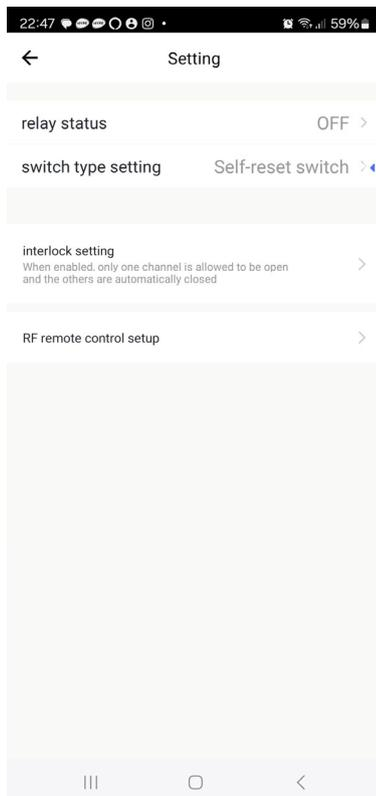
**RELAY STATUS** – Qui puoi impostare lo stato che i relè devono acquisire all'avvio del dispositivo, dopo che si è verificata una mancanza rete. Puoi scegliere ON, OFF oppure MEMORY che significa ripristinare lo stato attivo prima della mancanza rete.
