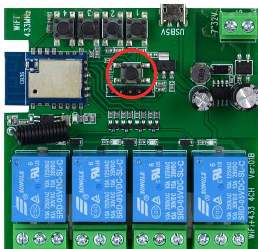
Al centro della scheda è presente il pulsante di reset. Se tieni premuto il pulsante di reset per 5 secondi ripristini le impostazioni di fabbrica e il dispositivo si porta in modalità di configurazione app con il LED blu che lampeggia velocemente.
