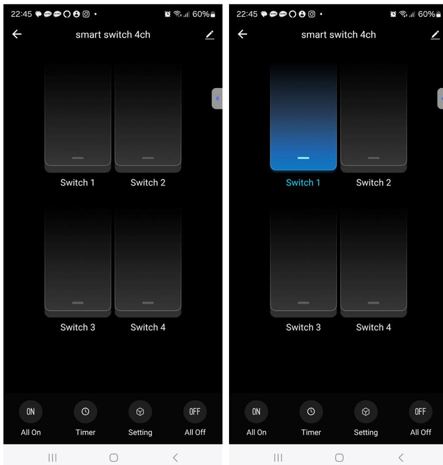
**ON/OFF** – Il 4 relè del telecomando si controllano semplicemente premendo i 4 pulsanti. L'icona del pulsante si colora di blu quando il telecomando è stato azionato (contatto aperto o chiuso a seconda di quale morsetto hai utilizzato). Il colore del pulsante è una memoria in tempo reale dello stato del relè per cui, ogni volta che apri l'app, puoi vedere subito la situazione in cui si trovano i relè
